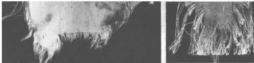
Figure III-9-15. Effilochage. Bords rompus devenus duveteux après le claquement au vent (à gauche). Rupture après effilochage (à droite).
