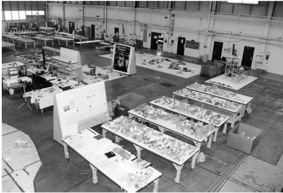
Figure III-8-3. Disposition de la reconstitution de systèmes du vol Swissair 111 (photo publiée avec l'autorisation du Bureau de la sécurité des transports du Canada)
