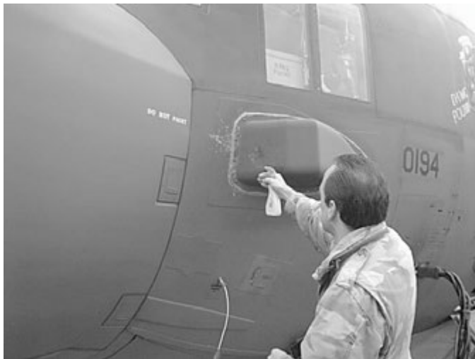
Figure III-5-5. Un enquêteur pulvérise de l'eau propre sur ce qu'il soupçonne être un impact d'oiseau, puis l'essuie avec un linge propre.
