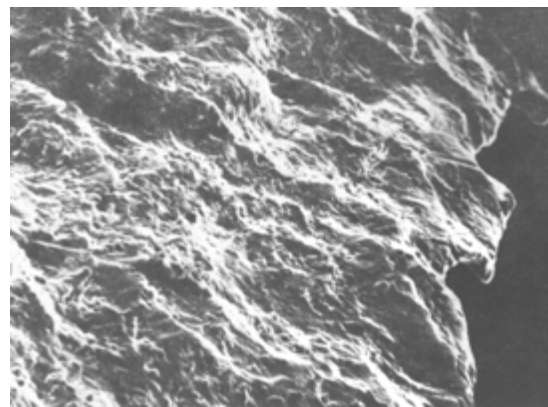
Figure III-19-5. Effet d'érosion et de fusion par les gaz sur un fragment du Comet (à gauche). Érosion et fusion par les gaz provenant de la déflagration de RDX sur un morceau d'aluminium (à droite).
