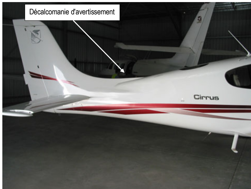
Figure III-13-13. Vue de côté de l'arrière du Cirrus indiquant la position des décalcomanies d'avertissement du CAPS sur le fuselage
