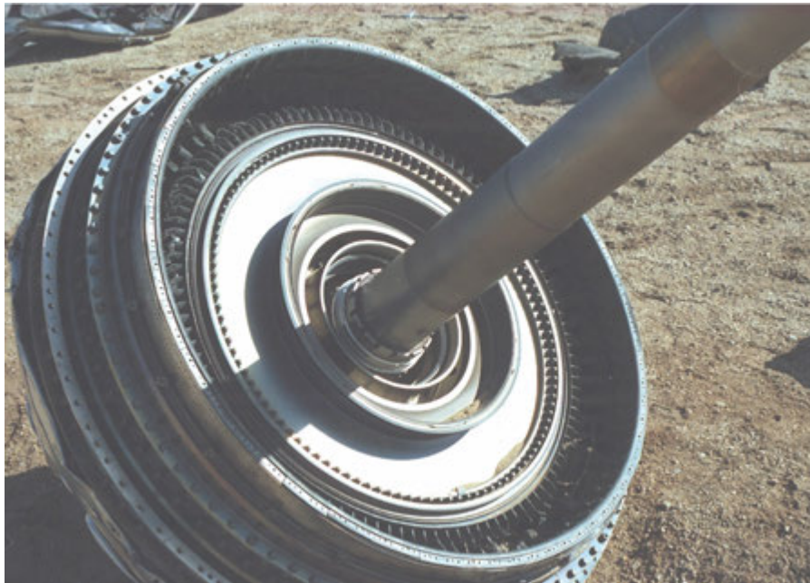
Figure III-2-1. Cette photo illustre le problème de la prise de photos avec le plein soleil comme seul éclairage. Elle vise à montrer les dommages causés par la chaleur à la section turbine, mais l'ombre masque la plupart des détails des dommages.
