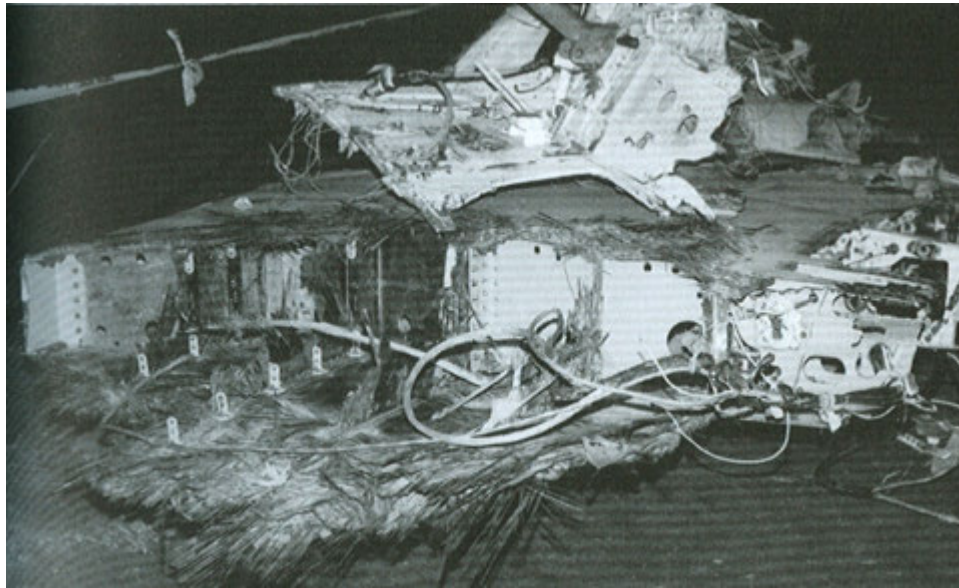
Figure III-9-32. Aile en matériau composite qui se serait rompue en flexion. La différence entre la surface relativement rugueuse de la rupture en traction et la surface relativement lisse de la rupture en compression est clairement visible.
