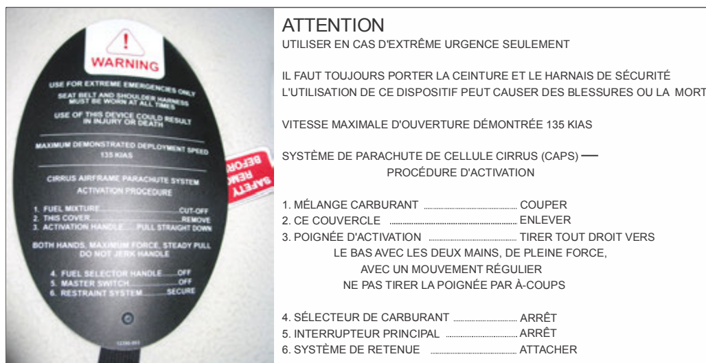
Figure III-13-12. Manette de déclenchement du CAPS située au plafond de la cabine
