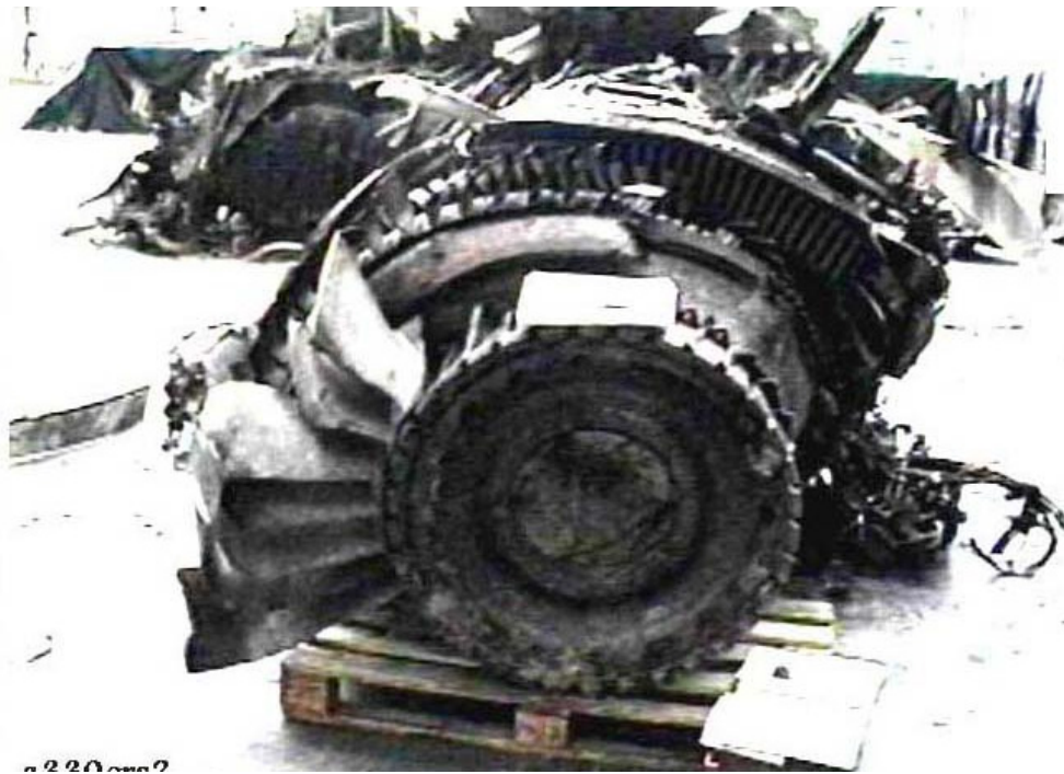
Figure III-12-4. Dommages causés à haute vitesse
