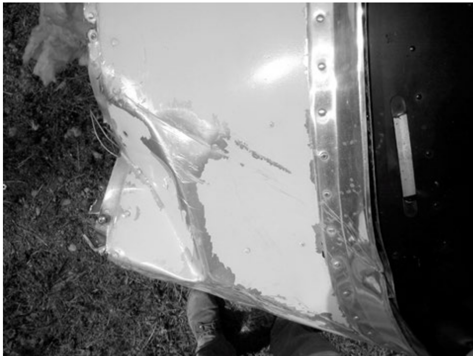
Figure III-10-3. Rayures sur une surface horizontale photographiées à la verticale. Noter les lignes droites.
