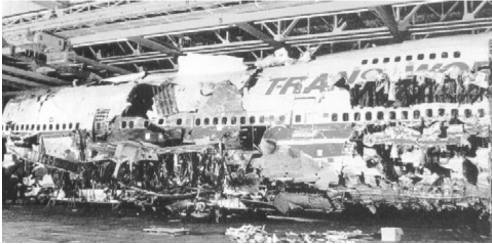
Figure III-8-5. Reconstitution de la section principale du fuselage de l'épave du vol TWA 800 (photo publiée avec l'autorisation du Bureau de la sécurité des transports du Canada)
