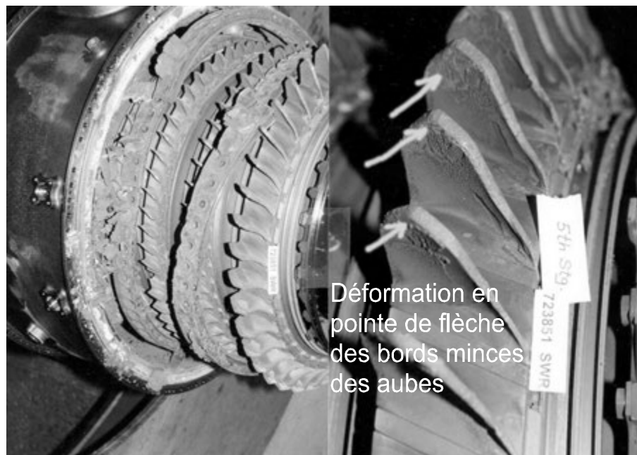
Figure III-12-26. Dommages causés par un feu de titane (noter la forme en pointe de flèche)
