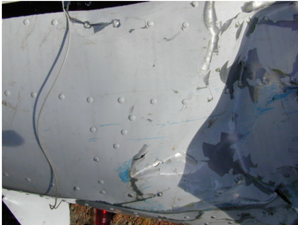
Figure III-10-4. Surface verticale d'un fuselage photographiée de côté. Noter les rayures droites et l'angle relativement faible formé par rapport à l'axe longitudinal, indiquant qu'il y a eu peu de mouvement vertical relatif dans cette collision.
