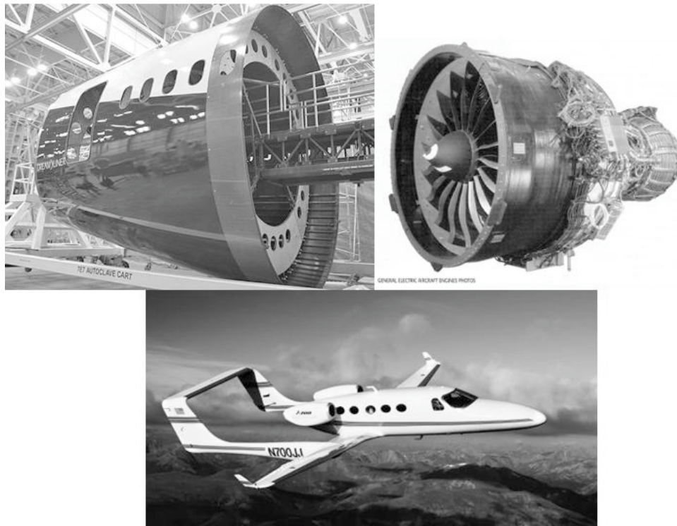
Figure III-9-21. Exemples de structures composites (à partir du coin supérieur gauche) : fuselage du Boeing 787, aubes et carter du moteur GEnx de General Electric et l'Adam A700 VLJ.
