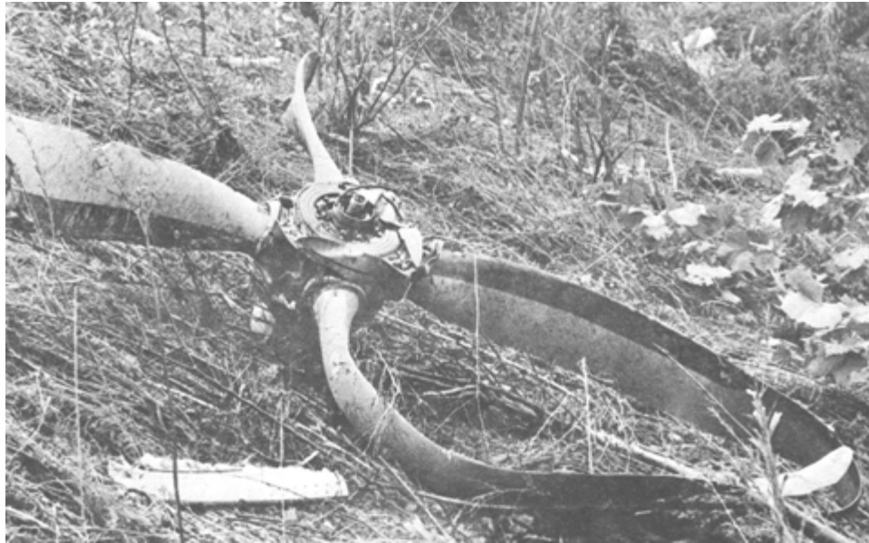
Figure III-12-31. Le moteur développait de la puissance au moment de l'impact.
