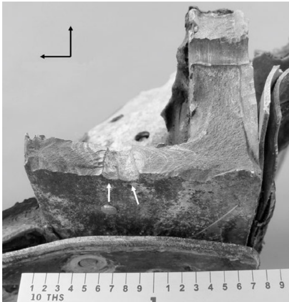
Figure III-9-25. Indications de fissures de fatigue dans la semelle du longeron inférieur droit de l'aile du Grumman Mallard G73 de Chalks Ocean Airways, qui s'est écrasé en décembre 2005. Cette photo est un exemple de l'application des connaissances et de l'expérience accumulées pour identifier les facteurs qui ont pu contribuer à l'accident.
