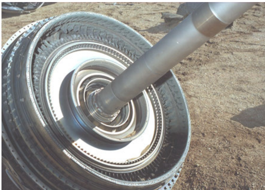
Figure III-2-2. Cette photo a été prise en utilisant un flash d'appoint assez puissant pour éclaircir les ombres créées par l'exposition en plein soleil. Les dommages causés à la section turbine sont clairement visibles.
