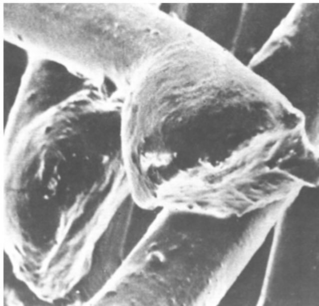
Figure III-19-18. Globules à l'extrémité des fibres montrant l'absence de noircissement et de bulles de gaz
