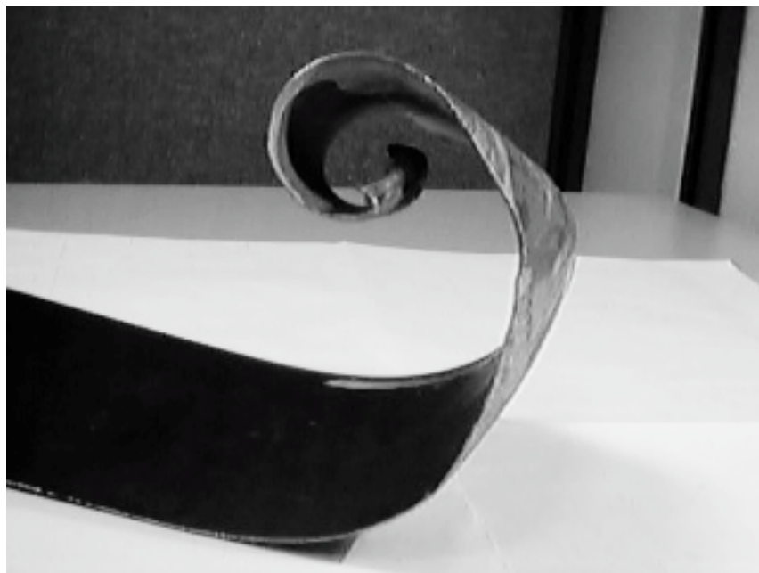
Figure III-12-35. Extrémité de l'hélice recourbée vers l'avant en raison d'un régime élevé lors d'un impact à faible angle
