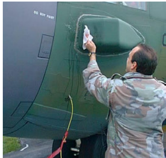
Figure III-5-5. Un enquêteur pulvérise de l'eau propre sur ce qu'il soupçonne être un impact d'oiseau, puis l'essuie avec un linge propre.
