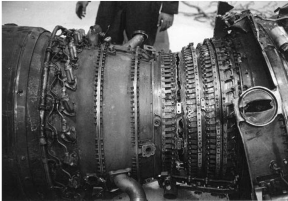
Figure III-12-27. Perçage par feu de titane
