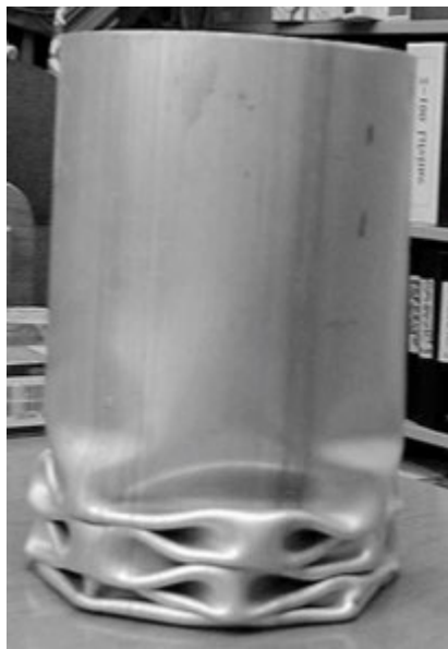
Figure III-9-9. Rupture par compression avec flambage (à gauche) Rupture par compression pure (à droite)
