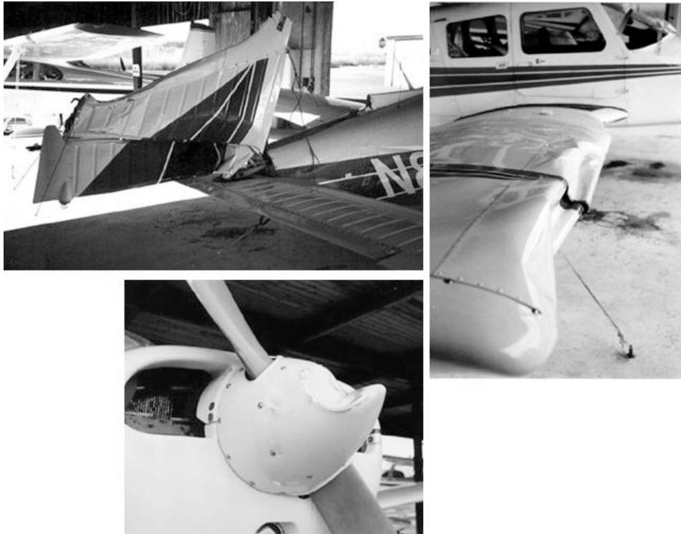
Figure III-9-24. La ductilité des structures de métal fournit des informations macroscopiques sur l'accident.
