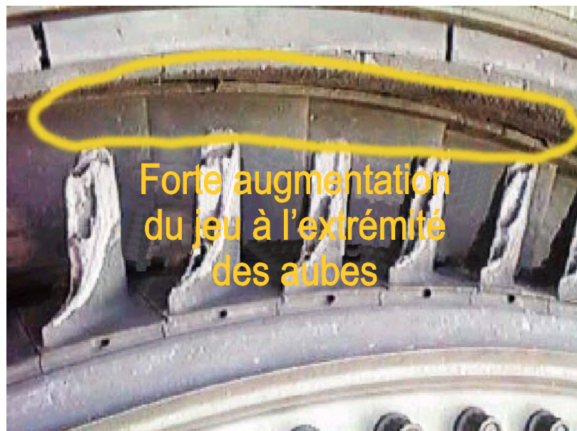
Figure III-12-24. Augmentation du jeu à l'extrémité des aubes causée par une surchauffe
